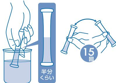
③そのまま穴を検水の中に入れ、つまんだ指をゆるめ、半分くらい水を吸い込むまで待ちます。液がもれないようにかるく15回程度振り混ぜます。
