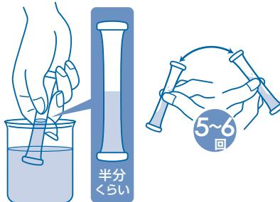
③そのまま穴を検水の中に入れ、つまんだ指をゆるめ、半分くらい水を吸い込むまで待ちます。液がもれないようにかるく5~6回振り混ぜます。
